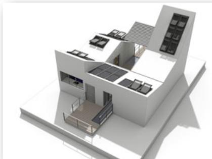
*àtika* ha forma, disposizione delle finestre, orientamento delle stanze e delle falde del tetto studiati per garantire ambienti salubri a ventilazione controllata, che consentono condizioni di benessere a 6°/8°C in meno: notevole quindi il risparmio energetico. Inoltre, con una finestra per tetto, si ottengono fino a 84 m<sup>3</sup>/h di ricambio d'aria in qualsiasi condizione climatica.
